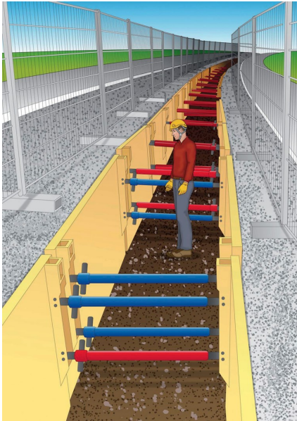
Sistema di protezione con puntelli a regolazione variabile
