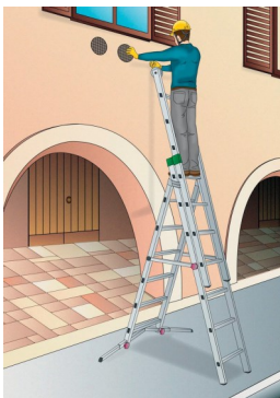
Esempio di scala trasformabile
